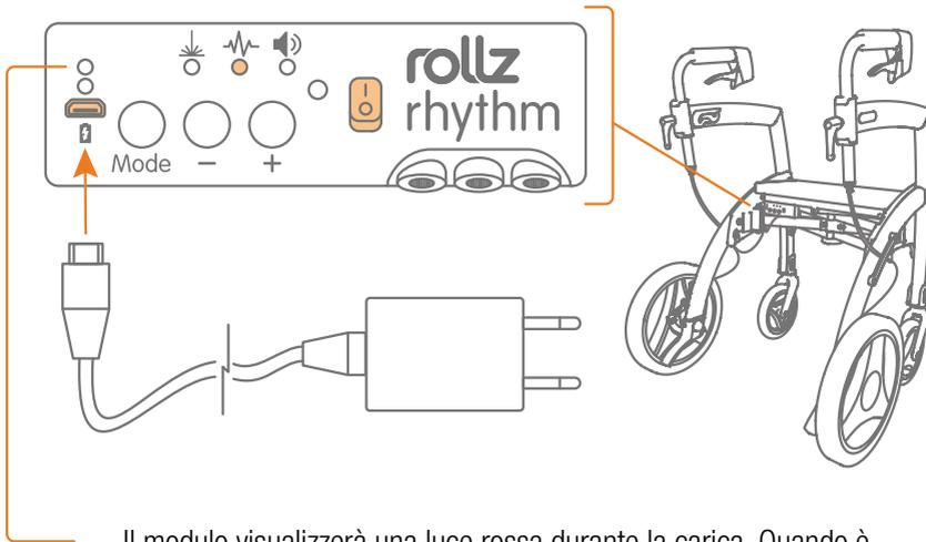
Il modulo visualizzerà una luce rossa durante la carica. Quando è completamente carica, questa luce diventerà verde. Caricare il modulo solo con un adattatore di 5V e 1A.
